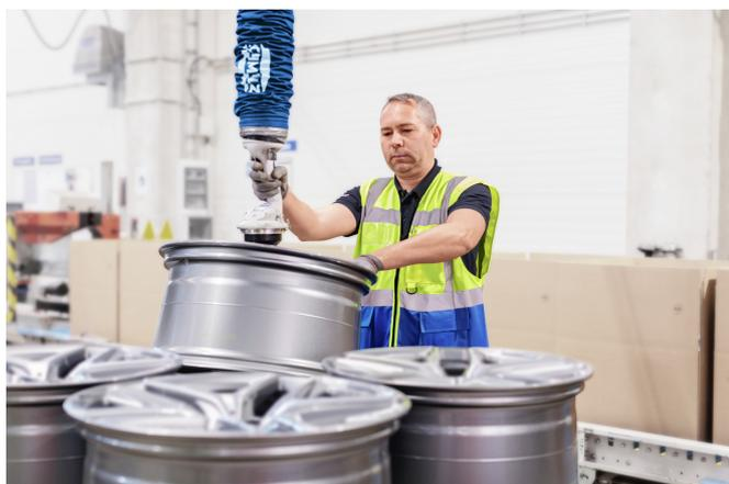
Der Felgengreifer für Vakuumschlauchheber JumboFlex handhabt schwere Felgen mit Leichtigkeit.
