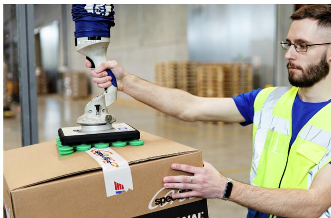
Der Schlauchheber JumboFlex mit Mehrfachgreifer nimmt Kartons unterschiedlicher Größe und Qualitäten sicher auf.
